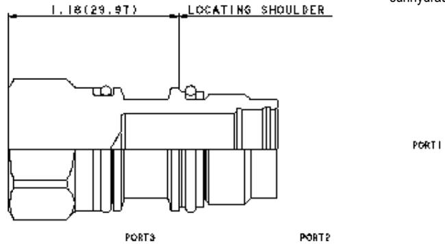
Dieser Verschlussstopfen verbindet die Anschlüsse 1 und 2 und sperrt Anschluss 3.
